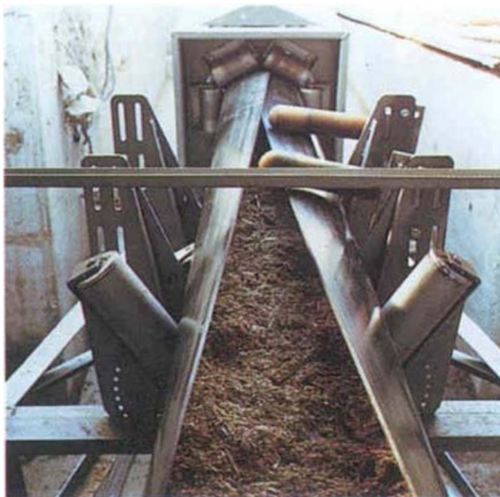
Рис. 2. Механизм сворачивания ленты (вариант)
