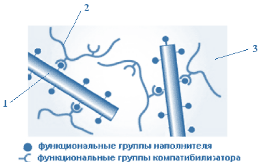
Рис. 2. Адгезионный механизм действия компатибилизатора: 1 – наполнитель, 2 – компатибилизатор, 3 – полимерно-битумная матрица
